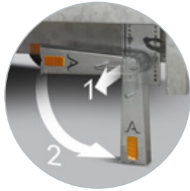
Zubehör; Abstellstützen können im Handumdrehen ausgeklappt werden
